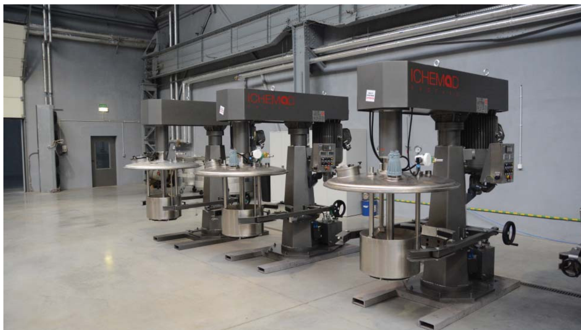
Погружные мельницы с охлаждающими корзинами в производственном цехе ICHEMAD-
