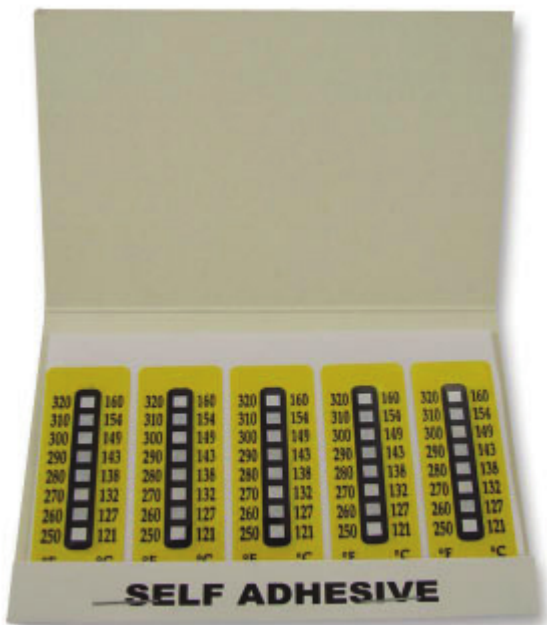
Мал. 7 Упаковка термоіндикаторних наклейок (стікерів).
