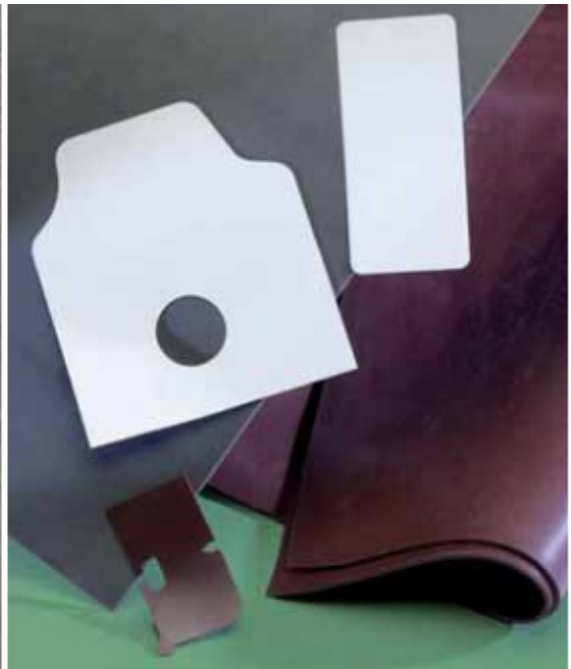
Фото. 2 Маскувальні елементи з магнітного силікону 1 мм і магнітного ПВХ 0,9 мм
