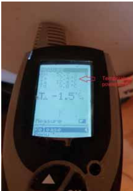
Фото. 5. Незважаючи на те, що в фарбувальному цеху досить тепло (+17,4°C) і сухо (57%), елемент настільки холодний, щоб на ньому виникла точка роси.
