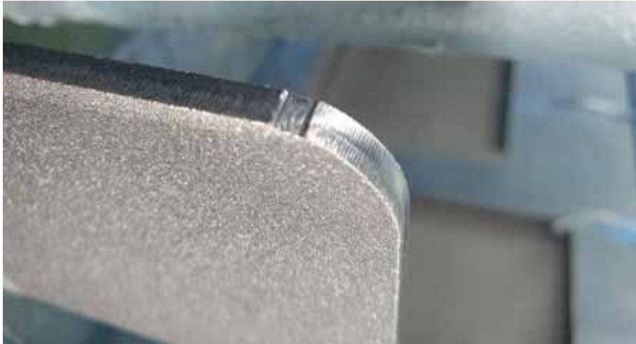
Фото. 3. На краях відсутні сліди абразиво-струминної обробки.
