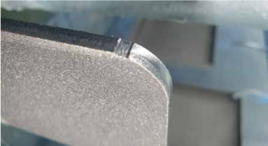
Фото. 3. На краях відсутні сліди абразиво-струминної обробки.
