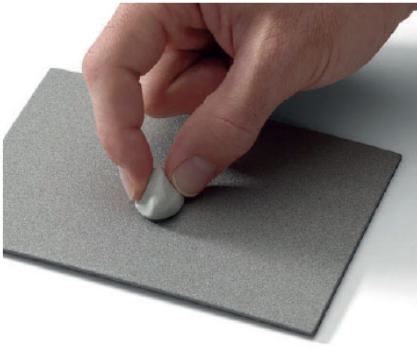
Фото. 9. Очищення досліджуваної поверхні.
