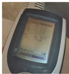
Фото. 6. Прилад вимірює: відносну вологість RH, температуру поверхні ts, температуру навколишнього середовища та t на основі цих даних дає температуру точки роси td і різницю між температурою основи та температурою точки роси TD.
