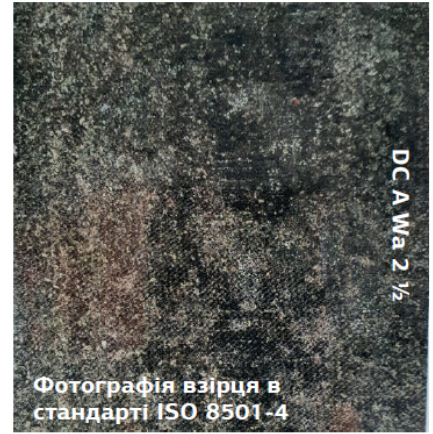
Фото. 4. Оцінка ступеня підготовки сталеві основи після очищення струменем води під високим тиском.
