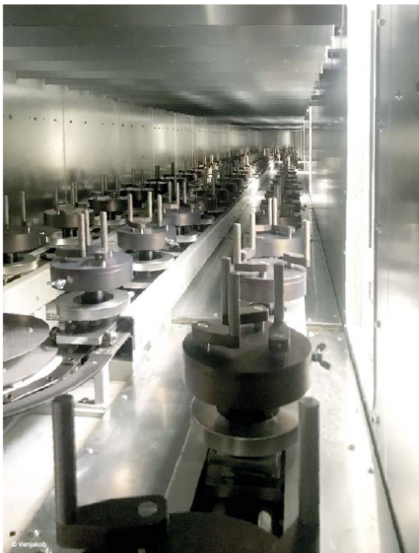
Сушильна камера з плавним регулюванням температури у діапазоні 50-90 °С.
