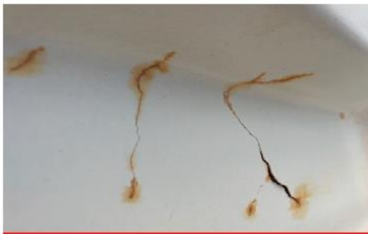
Фото. Розтріскування верхнього шару із плямами іржі.
