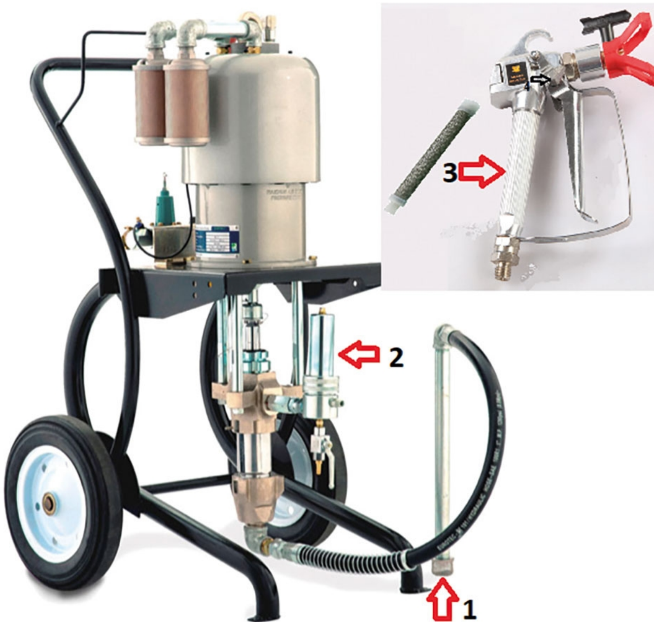
Фото.4. Розташування фільтрів в більшості установок для безповітряного фарбування.
