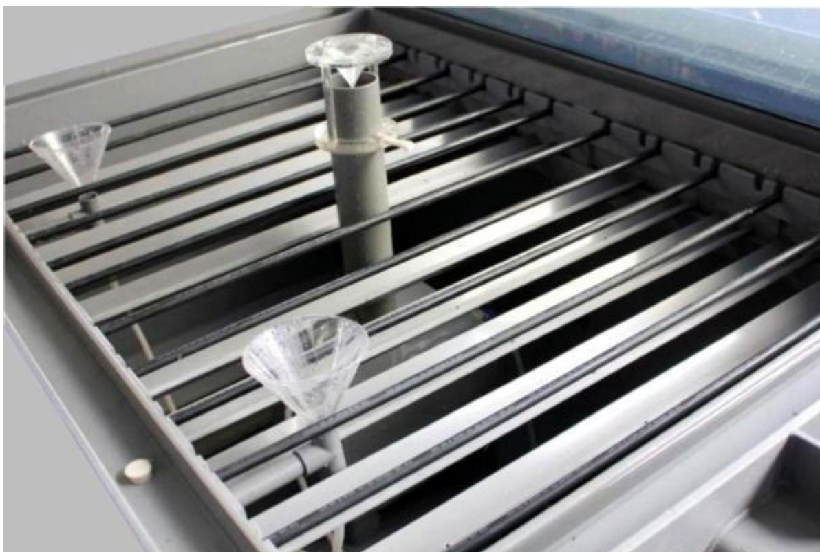
Внутрішній вигляд камери соляного туману
