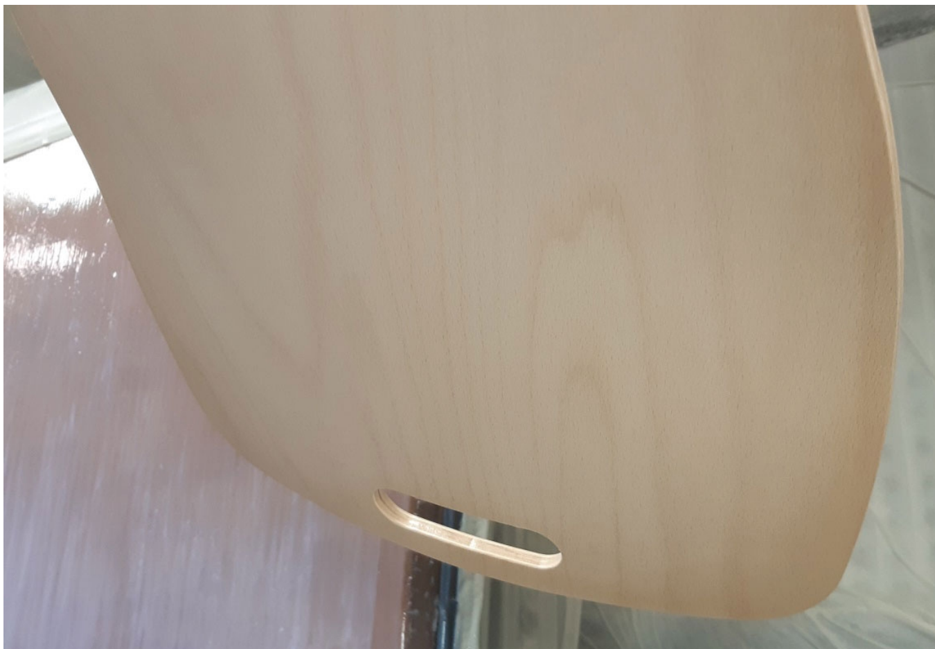
Рис. 15. Ефект потовщення покриття на краях елементі з гнутоклеєної фанери.
