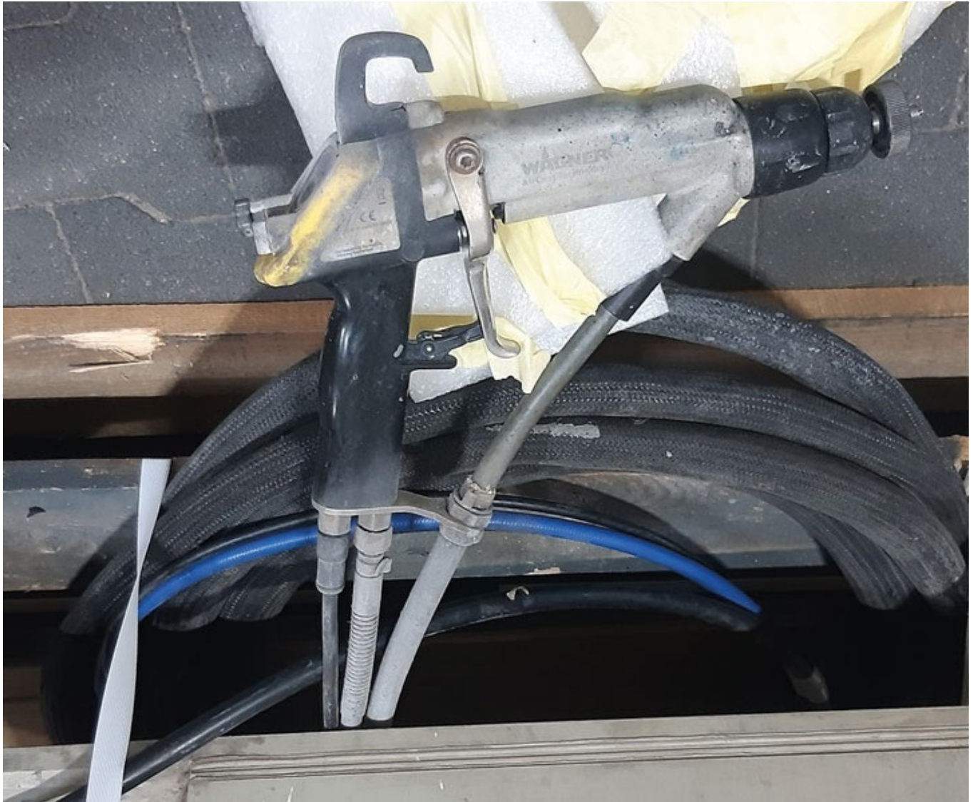
Рис. 2. Електростатичний пістолет WAGNER AQUA COAT
