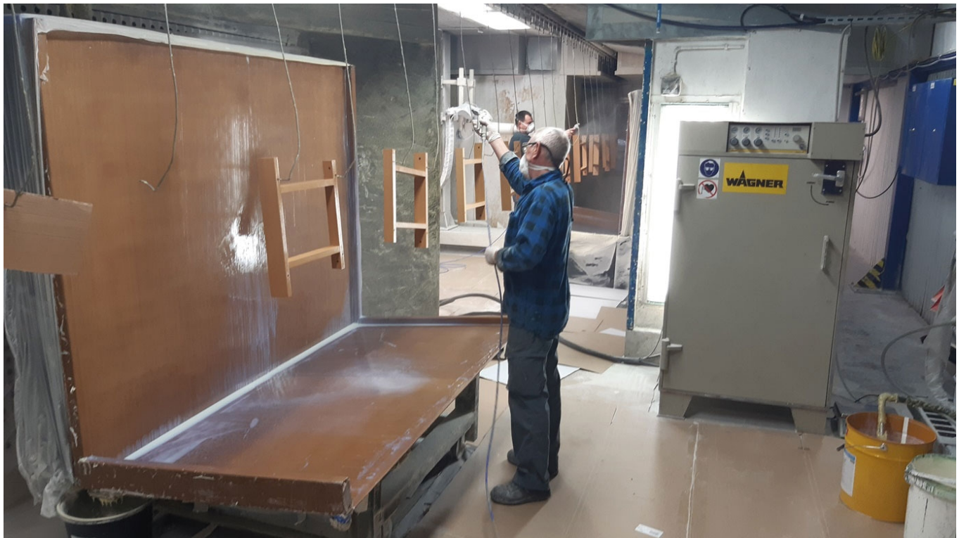
Рис. 11. Пост для електростатичного розпилення.
