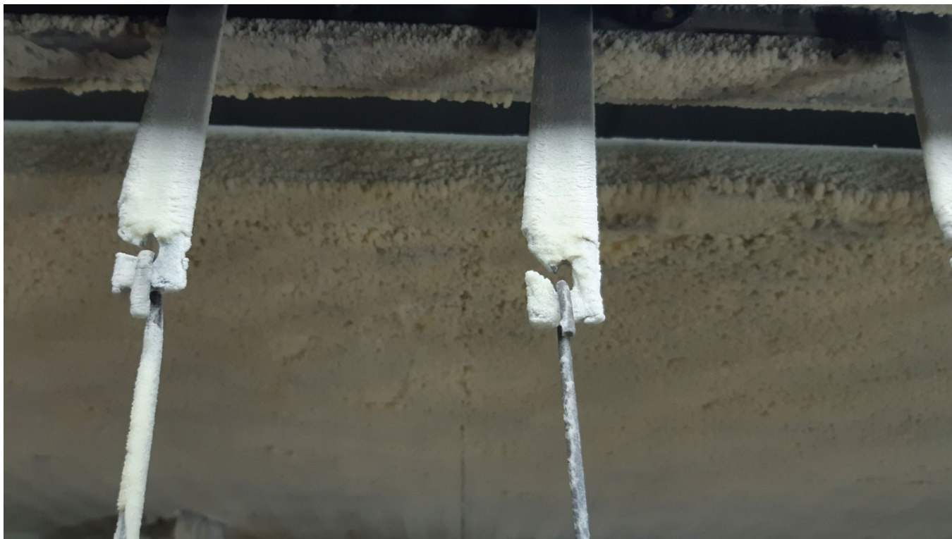
Рис. 5. Приклад сильно забруднених гачків, які перешкоджають належному заземленню фарбованого елемента.
