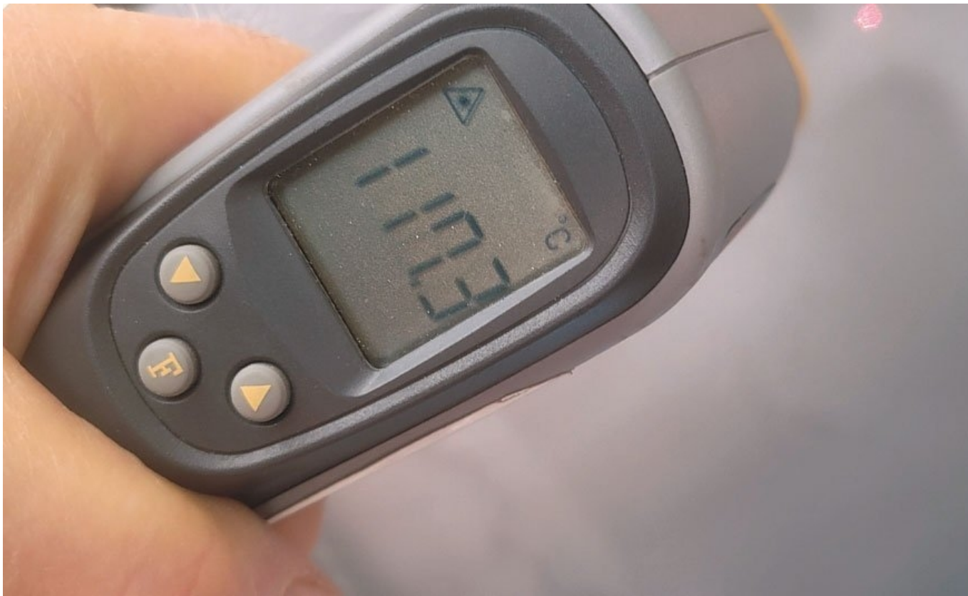
Фото. 1. Вимірювання температури поверхні, підготовленої до фарбування
