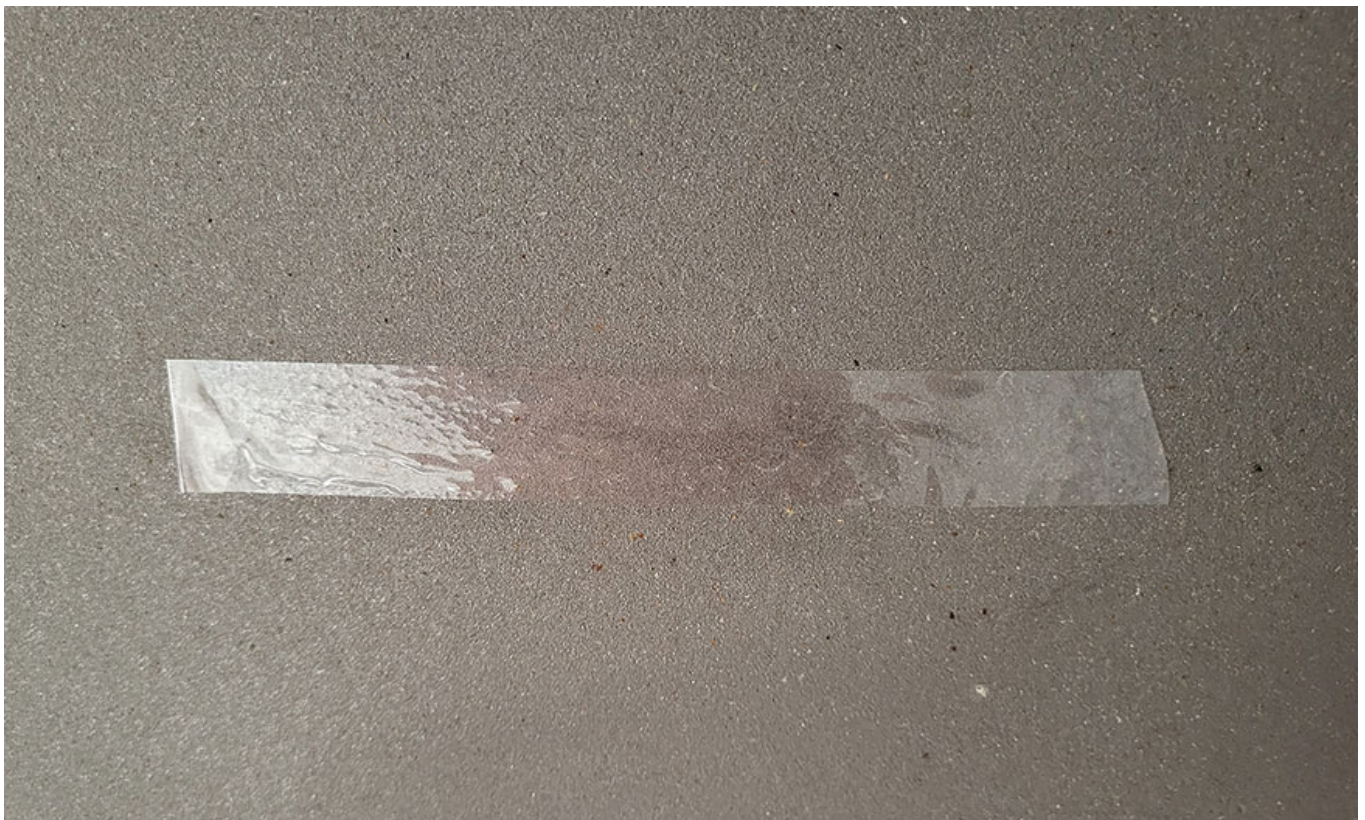
Фото. 6. Стрічка для оцінки запиленості, приклеєна до поверхні з температурою понад 80С.
