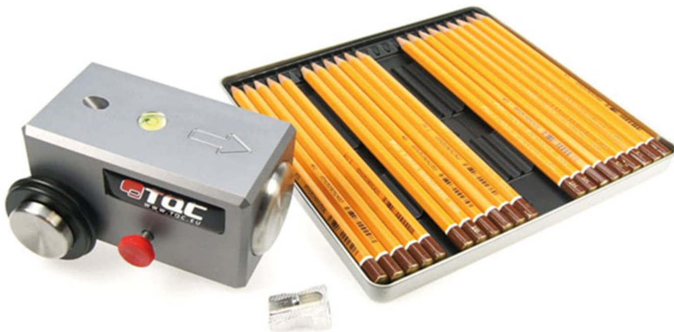
Рис. 2. Твердомір TQC Sheep з набором олівців
