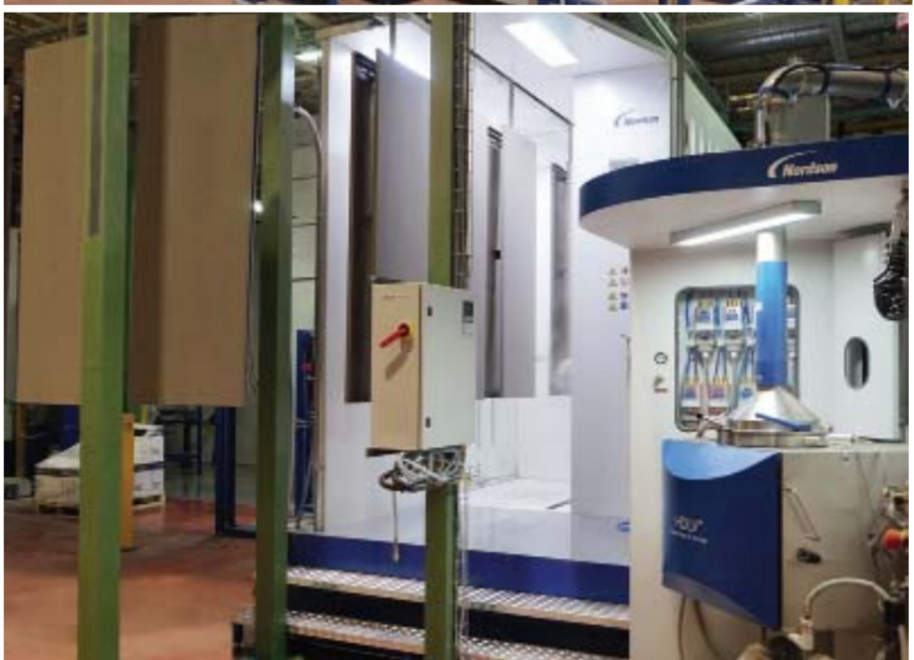
Фото. 3. Камера швидкої зміни кольору Nordson ColorMax3, пістолети Encore HD і центр
