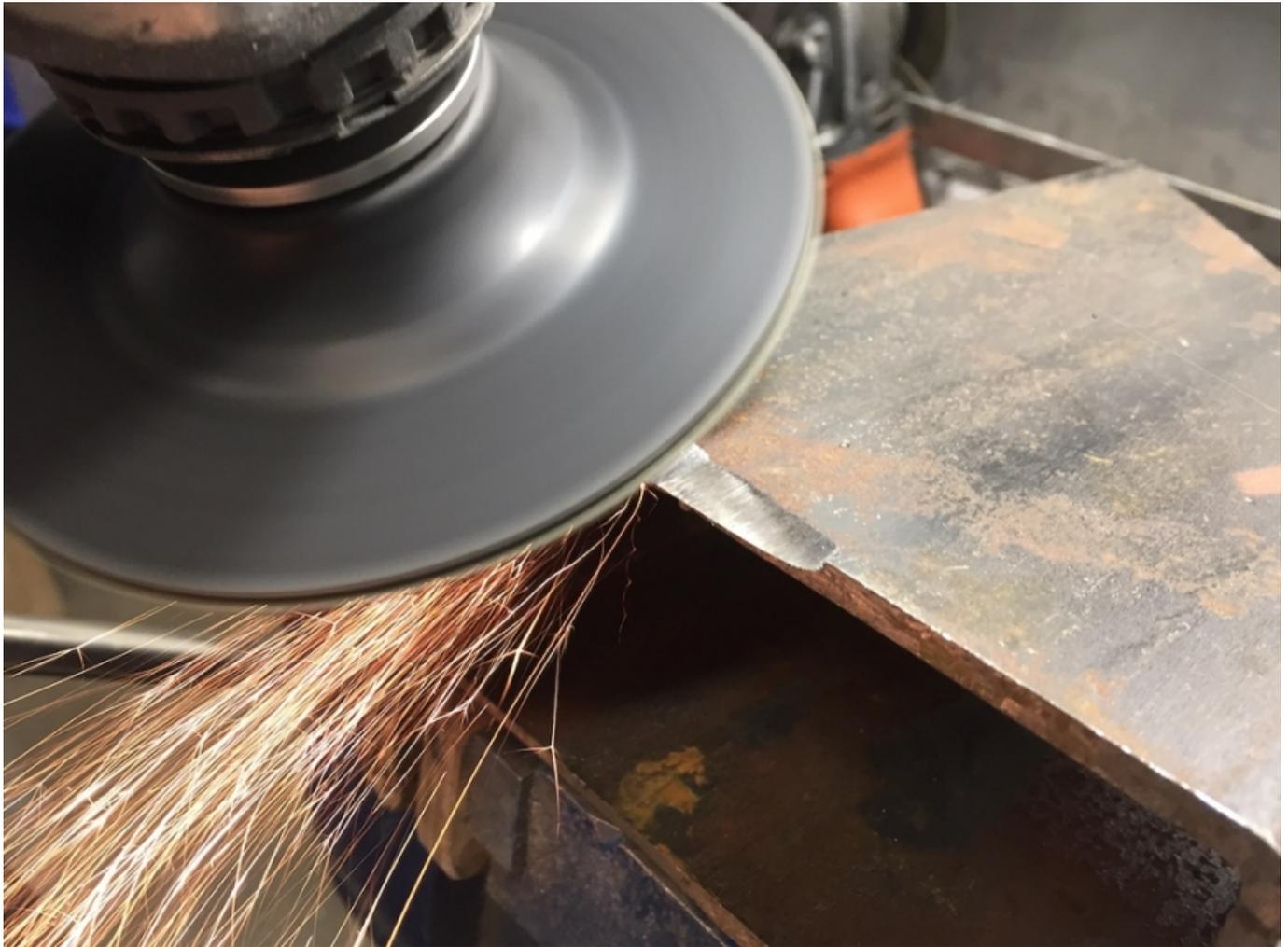
**Фибровый круг - это расходный инструмент, предназначенный для зачистки и шлифования различных видов металлических заготовок. Он выглядит в виде диска, у которого поверхность покрыта слоем абразивных частиц, в центре диска имеется сквозное отверстие.**
