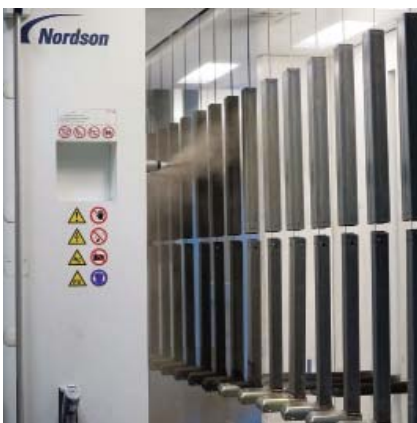
М'яке розпилення порошкової фарби в системі Encore HD забезпечує повний контроль процесу.
